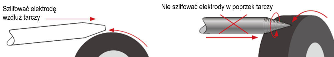
Rys. 14. Szlifowanie elektrody wolframowej
