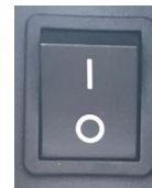
Wyłącznik układu chłodzenia
